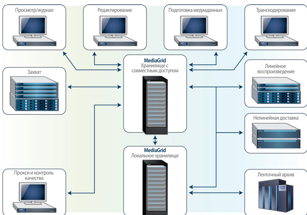
*MediaGrid: Система хранения данных с совместным доступом управляет рабочими процессами по обработке медиаданных на файловой основе*
